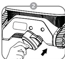
2 Connectez le chargeur à induction au robot
