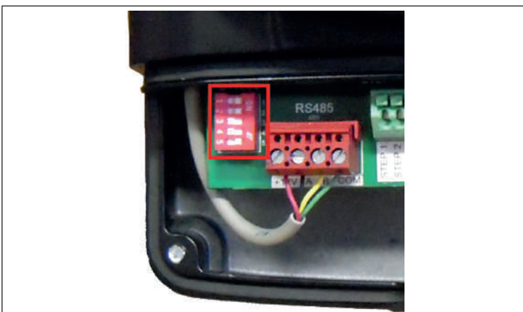
Position des switches pour le pilotage par l'interface utilisateur
